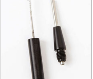
Abbildung 3: Entfernte Verschlusskappe, zur Reinigung freigelegte Bürste der Sondenspitze
