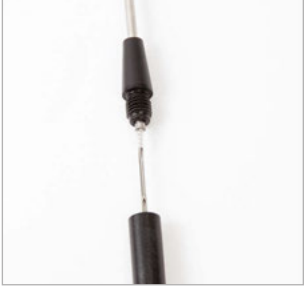
Abbildung 2: Abgeschraubte und teilweise entfernte Verschlusskappe
